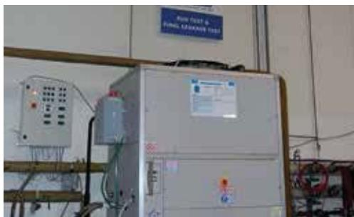
Производственный цикл подходит к концу на испытательном стенде. Здесь все модели чиллеров проходят индивидуальное тестирование для проверки правильности работы, заправки хладагентом и настроек микропроцессора.
