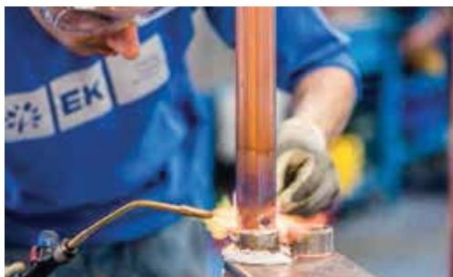
Следующая станция – это сборка охлаждающего контура, где собираются и припаиваются трубы контура, которые соединяются с различными агрегатами, (компрессорами, конденсаторами, испарителями и т. д.). Охлаждающий контур специально разработан таким образом, чтобы минимизировать потери нагрузки и избежать снижения производительности. Контур полностью изготовлен из медной трубки, в качестве припоя используется серебряный сплав. Он изолирован на всасывающей части, чтобы избежать образование конденсата.
