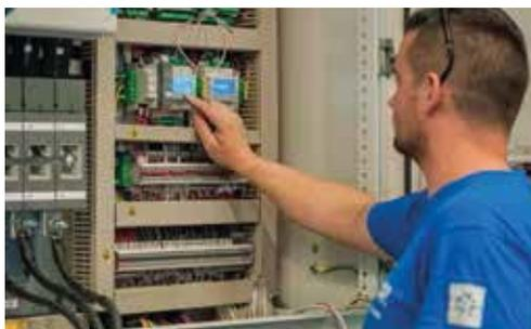
После сборки водяного и холодильного контура мы выполняем монтаж электропроводки между электрическими платами, компрессорами, вентиляторами, насосами и т.д. Каждый агрегат оснащен электрической панелью, собран, подключен и полностью протестирован на заводе. Нумерация проводов и оптимизированная компоновка упрощают поиск и устранение неисправностей. Установленные компоненты обозначены табличками с именами для упрощения идентификации.
