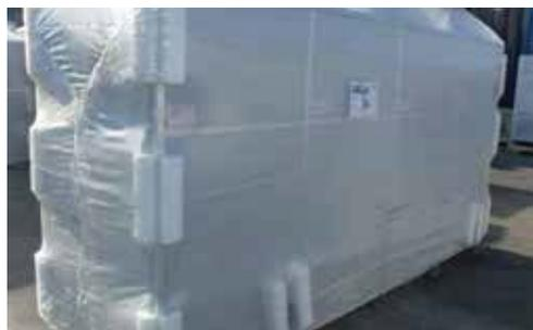
Последний этап производственного цикла - упаковка для отправки чиллера заказчику. Стандартная упаковка - это термоусаживаемая пластиковая пленка. Она покрывает весь чиллер и защищает его от пыли и влаги. На углах устанавливаются уголки из полистирола для защиты от возможных повреждений во время транспортировки. По желанию заказчика возможна специальная упаковка.
