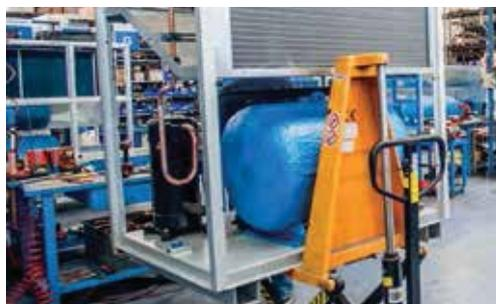
Производство агрегатов начинается на цехе механической сборки. Здесь собираются конструкции, устанавливаются и фиксируются основные компоненты, такие как компрессоры и теплообменники.
