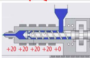
**Увеличьте температуру шнека/цилиндра (кроме зоны загрузки материала) на 10-30°C.** Эта операция необязательна, но она поможет лучше очистить шnek/материальный цилиндр. Температура шнека / цилиндра(кроме зоны загрузки), а также сопла должна быть не менее 250 °C. Температурная кривая должна увеличиваться по всей длине шнека. Температура в зоне загрузки должна быть самой низкой, а температура сопла - самой высокой!
