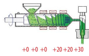
**Увеличьте температуру экструзионной головки на 20-30° С.**
