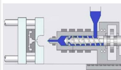
**Необходимо обязательно делать впрыск материала при отведенном от формы узле впрыска, а не прогонять материал через шнек/материальный цилиндр в режиме очистки шнека термопластомата. Смесь химического действия, для возникновения химической реакции необходимо давление и температура. Доза впрыска должна быть максимальной.**
