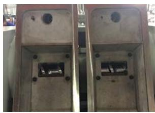
**Чтобы смесь не выходила из вентиляционных отверстий, рекомендуется закрыть их или загружать материал в шнек постепенно.** Если смесь выходит из вентиляционных отверстий увеличьте скорость шнека. Если на вашей машине вентиляционные отверстия работают через насос отключите его.
