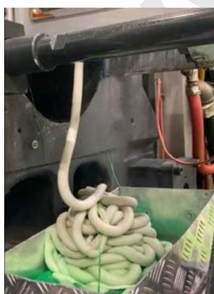
**Установите гидравлическое противодавление машины не менее 5-10 бар (или реактивное противодавление 30-90 бар).** Таблица перевода гидравлического противодавления в реактивное, в зависимости от диаметра шнека, приведена на следующей странице. Если из-за противодавления смесь Ultra Plast не будет загружаться в цилиндр, необходимо:
