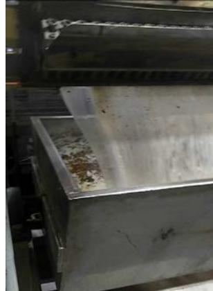
**Поверх очищающей смеси Ultra Plast загрузите в машину некоторое количество бесцветного полимерного материала (который планируется использовать для производства) и полностью прогоните его через шнековую пару и экструдизационную головку, чтобы удалить остатки очищающей смеси из машины.**
