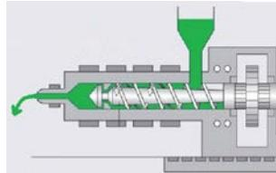
Перед очисткой горячеканальной системы рекомендуется с помощью смеси Ultra Plast предварительно очистить шnek/материалный цилиндр ТПА от возможного нагара. Инструкцию по очистке смотри выше. В этом случае, удалять остатки очищающей смеси Ultra Plast не нужно. Сразу загружайте в бункер термопластавтомата количество очищающей смеси достаточной для очистки шнека/материалного цилиндра и ГКС. После очистки шнека/цилиндра сразу приступайте к очистке ГКС.
