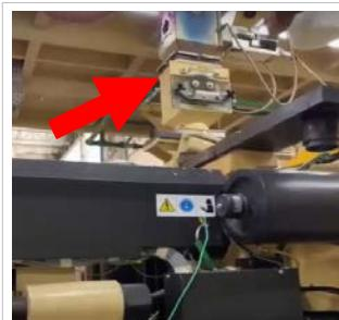
**Когда очищающая смесь Ultra Plast PET-CS будет загружена в материальный цилиндр, верните задвижку в закрытое положение, чтобы производственный ПЭТФ мог немедленно следовать за очищающей смесью Ultra Plast PET-CS**
