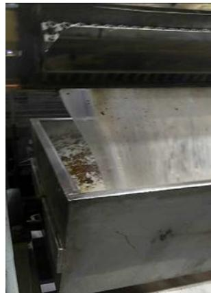
**Поверх очищающей смеси Ultra Plast** загрузите в машину некоторое количество бесцветного полимерного материала (который планируется использовать для производства) и полностью прогоните его через шнековую пару и экструзионную головку, чтобы удалить остатки очищающей смеси из машины.
