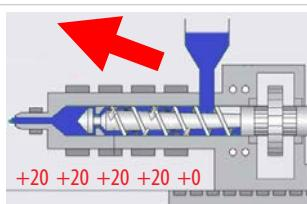
По всем зонам материального цилиндра установите рабочую температуру, при которой вы перерабатываете ПЭТ. Установите температуру в зоне загрузки материала не более 260°C.
