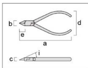
Кусачки с тонкими лезвиями режут литники не дробя их, оставляя на изделии более гладкую поверхность. Попробуйте и почувствуйте разницу.
