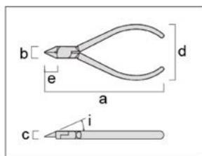
Кусачки мини для тонких литников, не требующих больших усилий. Уникальная конструкция петель и методковки смещают лезвия по оси друг от друга, для создания дополнительного давления на литник при резке.
