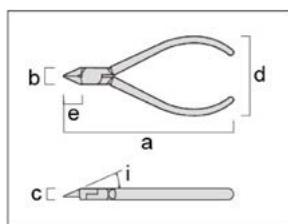
Усиленные кусачки разработаны специально для резки больших, тяжелых и жестких литников таких как эпоксидная смола со стекловолокном. Лезвия из стали с высоким содержанием углерода отшлифованы и отполированы для достижения острых лезвий, способных гладко обрезать пластик. В кусачки вставлены пружины для продолжительной резки. Санитарные антибактериальные рукоятки устанавливаются для длительного использования.
