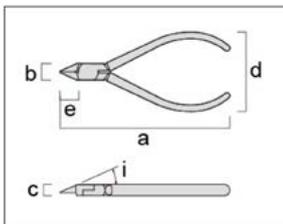
Торцевые кусачки подходят для резки литников и облоя в трубчатых отверстиях. Эти кусачки имеют круглые лезвия и санитарные антибактериальные рукоятки устанавливаются для длительного использования.
