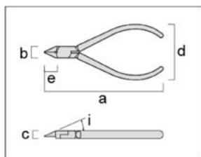
Усиленные кусачки разработаны специально для резки больших литников меньшим усилием. Уникальная конструкция петель и методковки смещают лезвия по оси друг от друга, для создания дополнительного давления на литник при резке. Эти кусачки предназначены для резки больших и стеклонаполненных литников. Доступны кусачки длиной в 183 и 200 мм.
