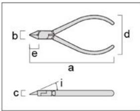
Кусачки с одним лезвием предназначены для резки прочных литников из композитных материалов. Единое лезвие гладко отрезает пластик не оставляя заусенцев. В кусачки также вставлена пружина для легкой продолжительной резкой. Доступны с плоскими и круглыми лезвиями.
