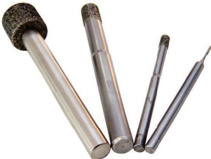
Ротационный борознозный инструмент Diprofil изготавливается из тщательно отобранного КНБ (кубического нитрида бора), которым равномерно покрывают инструмент для повышения прочности и износоустойчивости. Борознозный инструмент отлично подходит для работы с инструментальной и нержавеющей сталью, чугуном.
