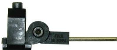
Шарнирный держатель инструмента для полировальных камней и шлифовальных планок максимальным сечением 11х13 мм или Ø 13 мм. Хвостовик Ø 3,0 мм.
