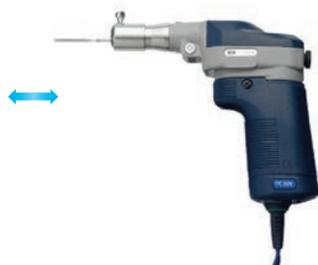
Профилировщики возвратно-поступательного действия RE55 обладают малым весом и являются удобным в эксплуатации ручным инструментом для непрерывного полирования. Обе модели имеют регулируемый ход и плавающую головку с поворотом на 360 градусов.
