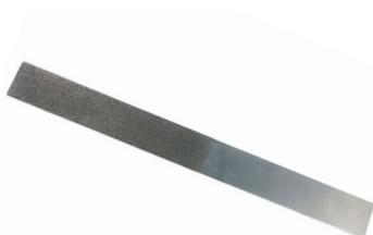
Общая длина 250 мм, ширина 25 мм, толщина 1,0 мм. Длина зоны покрытия 135 мм. Полностью алмазное покрытие.
