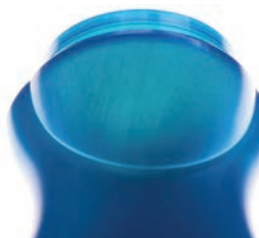
Корпус шарикового дезодоранта, отлитый с использованием статического смесителя Promix
