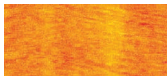
Термоскан укрывной пленки из полиэтилена при производстве со смесителем расплава Promix
