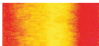
Термоскан укрывной пленки из полиэтилена при производстве без смесителя расплава Promix
