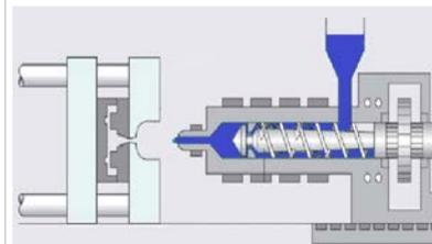
**Необходимо обязательно делать впрыск материала при отведенном от формы узле впрыска, а не прогонять материал через шнек/материальный цилиндр в режиме очистки шнека термопластавтомата. Смесь химического действия, для возникновения химической реакции необходимо давление и температура. Доза впрыска должна быть максимальной.**
