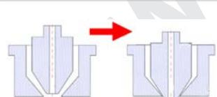
**Затяните сопла как можно больше. Чистящий материал должен выходить под давлением.** Если затянуть сопла невозможно (это характерно для большинства китайских машин) увеличьте скорость вращения шнека для того чтобы создать давление. Если очищающая смесь будет выходить очень медленно, немного приоткройте сопла.
