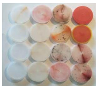
**Загрузите в машину некоторое количество смеси Ultra Plast и начните производство изделий.** Для очистки ГКС необходимо использовать количество смеси равное 1-2 объема материального цилиндра. Количество зависит от многих факторов: полимерного материала, красителя, типа ГКС, количества гнезд пресс-формы, веса изделия.
