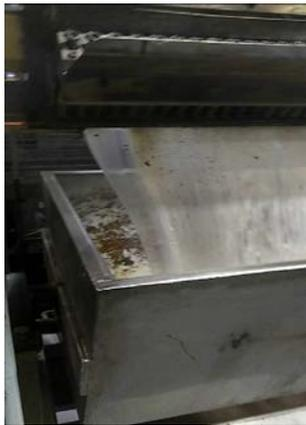
**Поверх очищающей смеси Ultra Plast загрузите в машину некоторое количество бесцветного полимерного материала (который планируется использовать для производства) и полностью прогоните его через шнековую пару и экструзионную головку, чтобы удалить остатки очищающей смеси из машины.**
