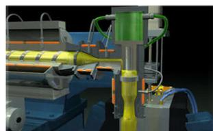
**Загрузите в бункер смесь Ultra Plast. Для очистки шнека/материального цилиндра необходимо использовать количество смеси равное 1-2 объема материального цилиндра.** Примерная таблица расчета в зависимости от диаметра шнека и отношении L/D приведена на первой странице.
