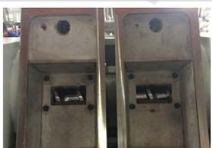
**Чтобы смесь не выходила из вентиляционных отверстий, рекомендуется закрыть их или загружать материал в шнек постепенно.** Если смесь выходит из вентиляционных отверстий увеличьте скорость шнека. Если на вашей машины вентиляционные отверстия работают через насос отключите его.
