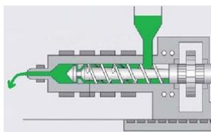
**Перед очисткой горячеканальной системы рекомендуется с помощью смеси Ultra Plast предварительно очистить шнек/материальный цилиндр ТПА от возможного нагара.** Инструкцию по очистке смотри выше. В этом случае, удалять остатки очищающей смеси Ultra Plast не нужно. Сразу загружайте в бункер термопластавтомата количество очищающей смеси достаточной для очистки шнека/материального цилиндра и ГКС. После очистки шнека/цилиндра сразу приступайте к очистке ГКС.
