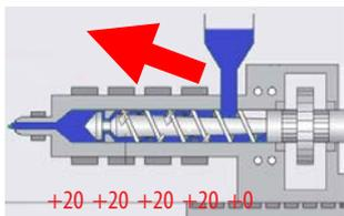
**Увеличьте температуру шнека/цилиндра (кроме зоны загрузки материала) на 10-30°C. При этом температура зоны загрузки не должна превышать 170°C.**
