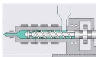
Очищающая смесь может быть загружена во внутрь цилиндра и использоваться как «антиоксидант». На время консервации оборудования, например, в выходные или праздничные дни, перед выключением оборудования загрузите смесь Ultra Plast полностью заполнив цилиндр, экструзионную головку. Бункер должен быть пустым (т. е. вы можете видеть шнек из зоны загрузки).
