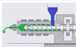
После включения машины увеличьте температуру во всех зонах до необходимой величины. Загрузите в бункер 1-2 кг смеси Ultra Plast и полностью прогоните её через шнековую пару. Затем загрузите в машину некоторое количество полимерного материала (который планируется использовать для производства) и полностью прогоните его через шнековую пару, чтобы удалить остатки смеси из машины. Начните производство изделий.
