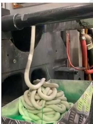
**Установите гидравлическое противодействие машины не менее 5-10 бар (или реактивное противодействие 30-90 бар).** Таблица перевода гидравлического противодействия в реактивное, в зависимости от диаметра шнека, приведена на следующей странице. Если из-за противодействия смесь Ultra Plast не будет загружаться в цилиндр, необходимо:
