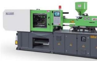
**Во время всей процедуры очистки материальный цилиндр не должен оставаться пустым. Загружайте все материалы последовательно, т.е. материал на котором нарабатывались изделия, затем смесь Ultra Plast, затем материал, на котором планируете нарабатывать изделия. В противном случае, может произойти слипание очищающей смеси Ultra Plast внутри материального цилиндра (так называемый «козел»).**
