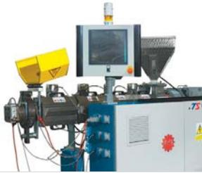
**Во время всей процедуры очистки материальный цилиндр не должен оставаться пустым. Загружайте все материалы последовательно, т.е. материал на котором нарабатывались изделия, затем смесь Ultra Plast, затем материал, на котором планируете нарабатывать изделия. В противном случае, может произойти слипание очищающей смеси Ultra Plast внутри материального цилиндра (так называемый «козел»).**
