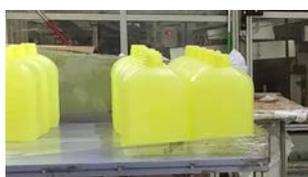
Когда материал будет выходить чистым, установите рабочие параметры (скорость вращения шнека, зазор сопла и т.д.) и начните производство.
