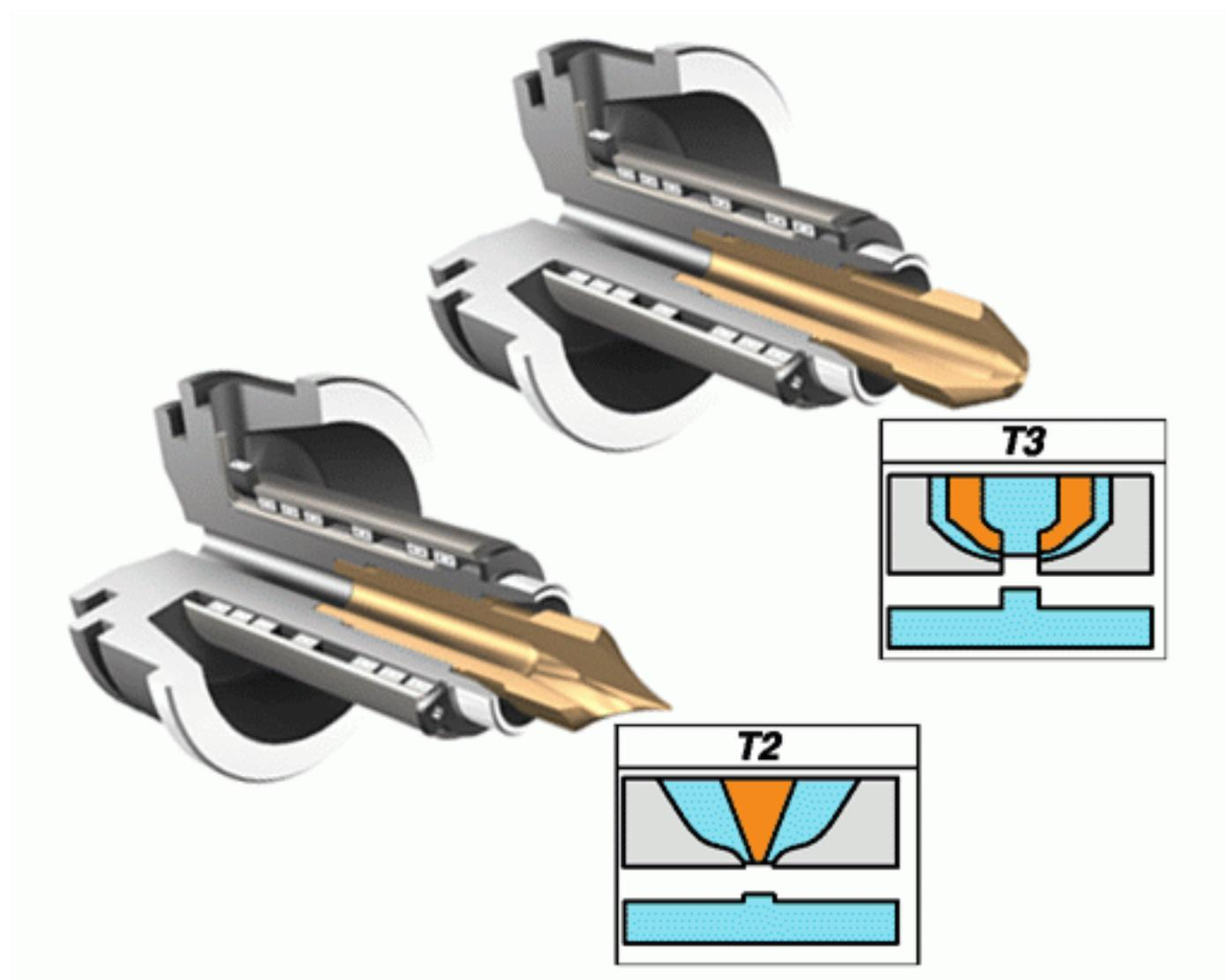
Форсунки прямого впрыска, подходящие для одногнездного и многогнездного применения, а также для: DL5400/5600 -
