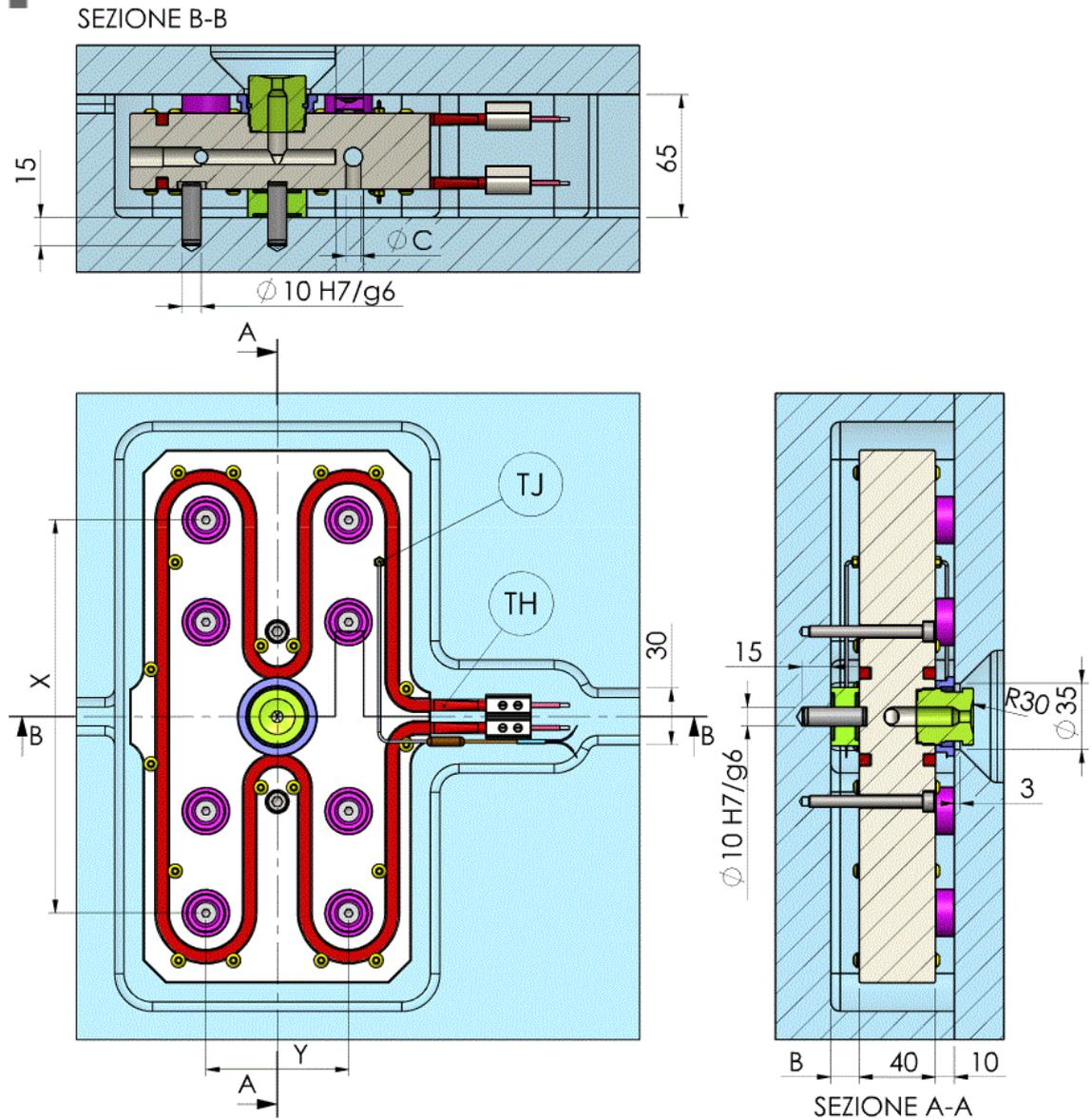
8 точек впрыска в две линии - 1+1 нагреватели - 1+1 термопары
