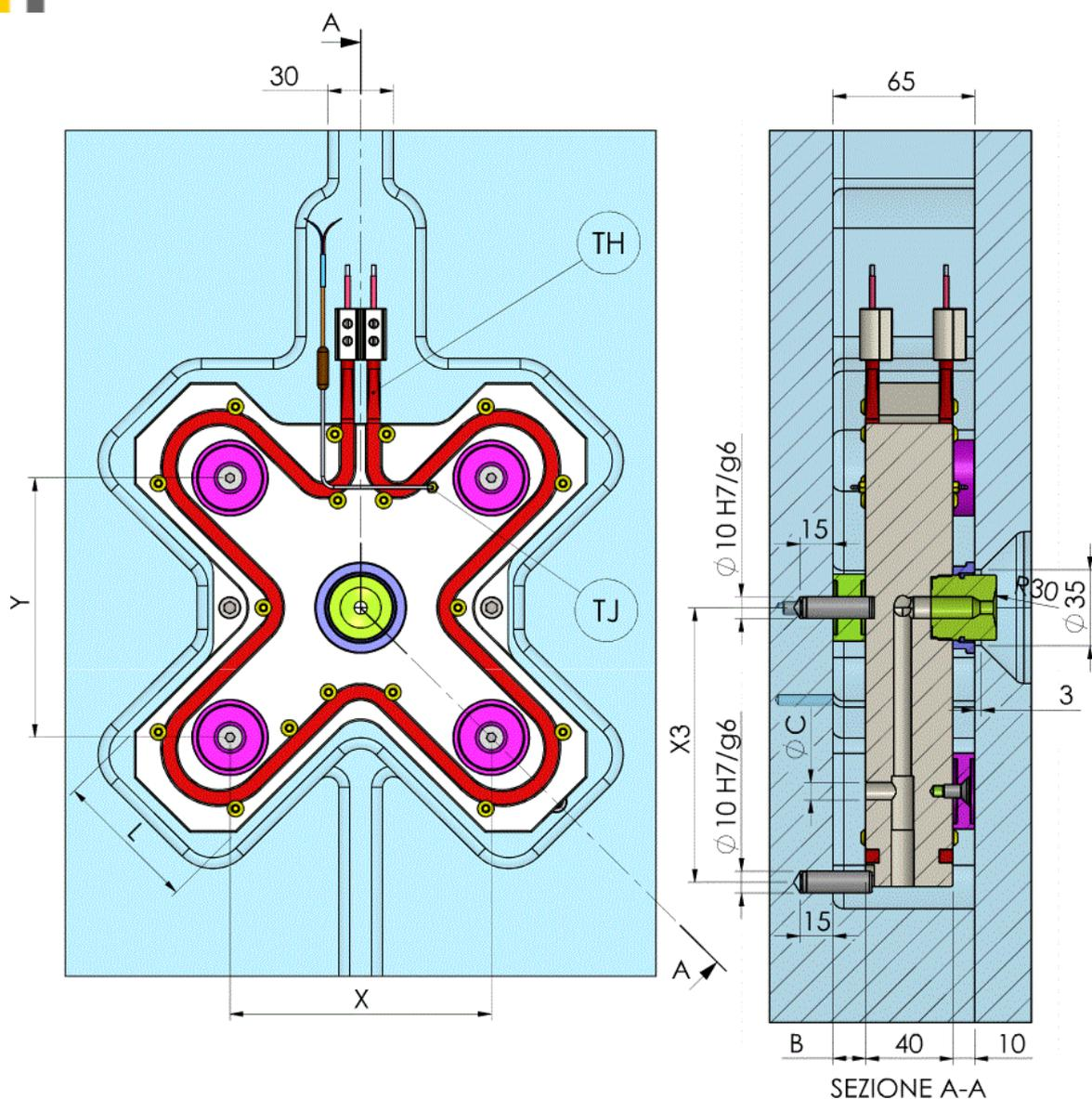
4 точки впрыска в две линии -1+1нагреватели - 1+1 термопары
