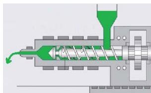
Перед очисткой горячеканальной системы рекомендуется с помощью смеси Ultra Plast предварительно очистить шnek/материальный цилиндр ТПА от возможного нагара. Инструкцию по очистке смотри выше. В этом случае, удалять остатки очищающей смеси Ultra Plast не нужно. Сразу загружайте в бункер термопластавтомата количество очищающей смеси достаточной для очистки шнека/материального цилиндра и ГКС. После очистки шнека/цилиндра сразу приступайте к очистке ГКС.
