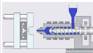
**Необходимо обязательно делать впрыск материала при отведенном от формы узле впрыска, а не прогонять материал через шнек/материалный цилиндр в режиме очистки шнека термопластавтомата. Смесь химического действия, для возникновения химической реакции необходимо давление и температура. Доза впрыска должна быть максимальной.**
