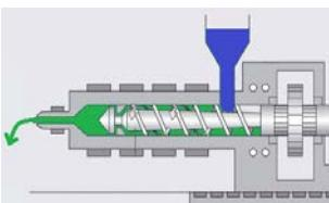
После включения машины увеличьте температуру во всех зонах до необходимой величины. Загрузите в бункер 1-2 кг смеси Ultra Plast и полностью прогоните её через шнековую пару. Затем загрузите в машину некоторое количество полимерного материала (который планируется использовать для производства) и полностью прогоните его через шнековую пару, чтобы удалить остатки смеси из машины. Начните производство изделий.
