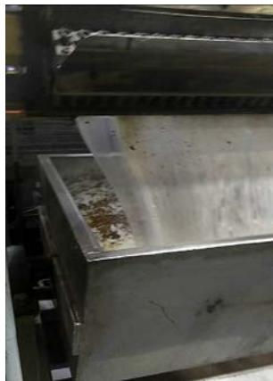
**Поверх очищающей смеси Ultra Plast загрузите в машину некоторое количество бесцветного полимерного материала (который планируется использовать для производства) и полностью прогоните его через шнековую пару и экструдционную головку, чтобы удалить остатки очищающей смеси из машины.**
