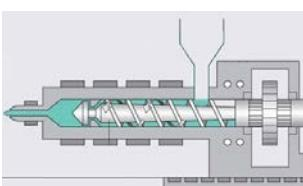
Очищающая смесь может быть загружена во внутрь цилиндра и использоваться как «антиоксидант». На время консервации оборудования, например, в выходные или праздничные дни, перед выключением оборудования загрузите смесь Ultra Plast полностью заполнив цилиндр, экструзионную головку. Бункер должен быть пустым (т. е. вы можете видеть шnek из зоны загрузки).
