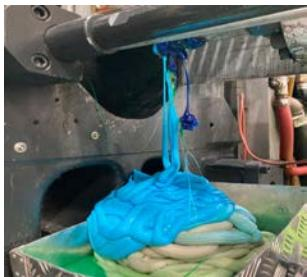
Поверх очищающей смеси Ultra Plast загрузите в машину некоторое количество бесцветного полимерного материала (который планируется использовать для производства) и полностью прогоните его через шнековую пару, чтобы удалить остатки очищающей смеси из машины.
