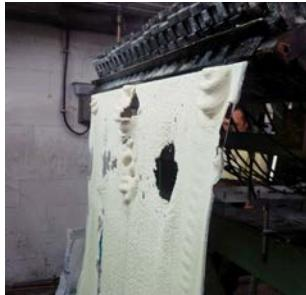
**Увеличьте температуру шнека/цилиндра (кроме зоны загрузки), а также экструдивной головки на 20-30°С. Температура шнека / цилиндра(кроме зоны загрузки), а также экструдционной головки должна быть не менее 250 °С.**
