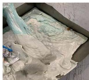
Сразу загрузите в машину некоторое количество бесцветного ПЭТФ и полностью прогоните его через шнековую пару, чтобы удалить остатки очищающей смеси из машины. ВАЖНО чтобы шнек всегда был заполнен ПЭТФ или очищающей смесь Ultra Plast.
