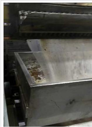
**Поверх очищающей смеси Ultra Plast загрузите в машину некоторое количество бесцветного полимерного материала (который планируется использовать для производства) и полностью прогоните его через шnekовую пару и экструзионную головку, чтобы удалить остатки очищающей смеси из машины.**
