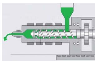
Перед очисткой горячеканальной системы рекомендуется с помощью смеси Ultra Plast предварительно очистить шnek/материальный цилиндр ТПА от возможного нагара. Инструкцию по очистке смотри выше. В этом случае, удалять остатки очищающей смеси Ultra Plast не нужно. Сразу загружайте в бункер термопластавтомата количество очищающей смеси достаточной для очистки шнека/материального цилиндра и ГКС. После очистки шнека/цилиндра сразу приступайте к очистке ГКС.
