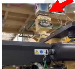
Когда производственный цикл стабилизируется, переместите задвижку вблизи загрузочного отверстия шнека, чтобы загрузить очищающую смесь Ultra Plast PET-CS. Для очистки горячеканальной системы необходимо использовать количество смеси равное 1-2 впрыскам.
