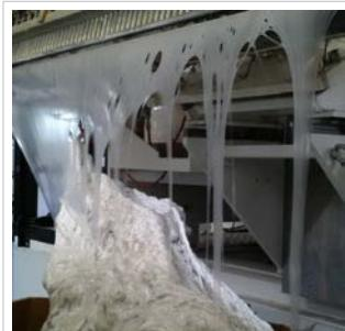
**ВАЖНО** чтобы температура шнека повышалась от зоны загрузки (самая низкая) до сопла (самая высокая). Очистку шнека/материального цилиндра необходимо обязательно производить вместе с экструзионной головкой
