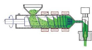
**Увеличьте температуру экструзионной головки на 20-30° С.**
