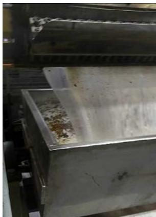
**Поверх очищающей смеси Ultra Plast загрузите в машину некоторое количество бесцветного полимерного материала (который планируется использовать для производства) и полностью прогоните его через шnekовую пару и экструдционную головку, чтобы удалить остатки очищающей смеси из машины.** Чтобы быстрее удалить остатки смеси Ultra Plast кратковременно увеличивайте и уменьшайте скорость вращения шнека. Данную процедуру необходимо провести 10-15 раз.
