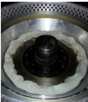
**Поверх очищающей смеси Ultra Plast загрузите в машину некоторое количество бесцветного полимерного материала (который планируется использовать для производства) и полностью прогоните его через шnekовую пару, чтобы удалить остатки очищающей смеси из машины.**
