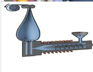
**Увеличьте температуру экструзионной головки на 20-30° С При этом температура зоны загрузки не должна превышать 170°С.**
