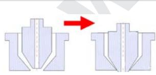
**Затяните сопла как можно больше. Чистящий материал должен выходить под давлением.** Если затянуть сопла невозможно (это характерно для большинства китайских машин) увеличьте скорость вращения шнека для того чтобы создать давление. Если очищающая смесь будет выходить очень медленно, немного приоткройте сопла.
