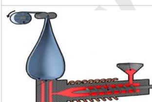
**Загрузите в бункер смесь Ultra Plast.** Для очистки шнека/материального цилиндра необходимо использовать количество смеси равное 1-2 объема материального цилиндра. Примерная таблица расчета в зависимости от диаметра шнека и отношении L/D приведена на первой странице.
