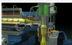
**Загрузите в бункер смесь Ultra Plast. Для очистки шнека/материального цилиндра необходимо использовать количество смеси равное 1-2 объема материального цилиндра.** Примерная таблица расчета в зависимости от диаметра шнека и отношении L/D приведена на первой странице.
