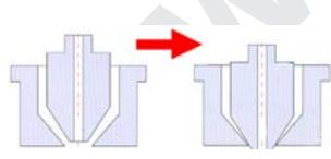
**Затяните сопла как можно больше. Чистящий материал должен выходить под давлением.** Если затянуть сопла невозможно (это характерно для большинства китайских машин) увеличьте скорость вращения шнека для того чтобы создать давление. Если очищающая смесь будет выходить очень медленно, немного приоткройте сопла.
