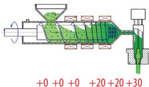
**Увеличьте температуру экструзионной головки на 20-30° C**
