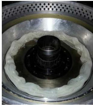
**Поверх очищающей смеси Ultra Plast загрузите в машину некоторое количество бесцветного полимерного материала (который планируется использовать для производства) и полностью прогоните его через шнековую пару, чтобы удалить остатки очищающей смеси из машины.**
