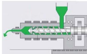
Перед очисткой горячеканальной системы рекомендуется с помощью смеси Ultra Plast предварительно очистить шnek/материальный цилиндр ТПА от возможного нагара. Инструкцию по очистке смотрите выше. В этом случае, удалять остатки очищающей смеси Ultra Plast не нужно. Сразу загружайте в бункер термопластавтомата количество очищающей смеси достаточной для очистки шнека/материального цилиндра и ГКС. После очистки шнека/цилиндра сразу приступайте к очистке ГКС.
