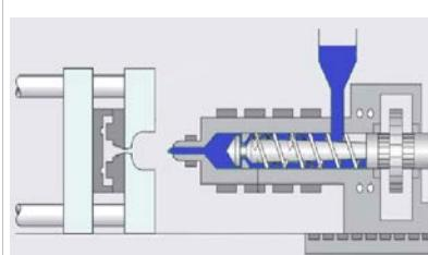
**Необходимо обязательно делать впрыск материала при отведенном от формы узле впрыска, а не прогонять материал через шнек/материальный цилиндр в режиме очистки шнека термопластомата. Смесь химического действия, для возникновения химической реакции необходимо давление и температура. Доза впрыска должна быть максимальной.**
