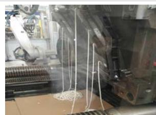
Очистку ГКС также можно производить, впрыскивая смесь через сопла ГКС при отведённом пuhanсоне. Рекомендуем закрыть пuhanсон, например, листом картона, чтобы после впрыска смеси он не был загрязнён.
