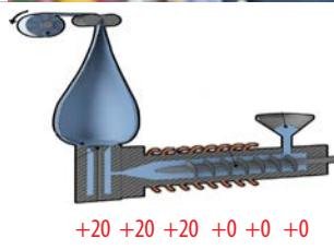
**Увеличите температуру экструзионной головки на 20-30° С При этом температура зоны загрузки не должна превышать 170°C.**
