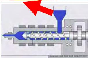
**Увеличьте температуру шнека/цилиндра (кроме зоны загрузки материала) на 10-30°C. При этом температура зоны загрузки не должна превышать 170°C.**
