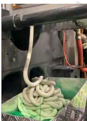
**Установите гидравлическое противодавление машины не менее 5-10 бар (или реактивное противодавление 30-90 бар).** Таблица перевода гидравлического противодавления в реактивное, в зависимости от диаметра шнека, приведена на следующей странице. Если из-за противодавления смесь Ultra Plast не будет загружаться в цилиндр, необходимо:
