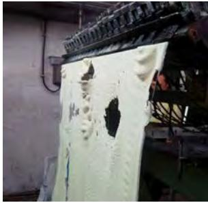
**Увеличьте температуру шнека/цилиндра (кроме зоны загрузки), а также экструзивной головки на 20-30°C. При этом температура зоны загрузки не должна превышать 170°C.** Очистку шнека/материального цилиндра необходимо обязательно производить вместе с экструзионной головкой. ВАЖНО чтобы температура шнека повышалась от зоны загрузки (самая низкая) до головки (самая высокая). Очистку шнека/материального цилиндра необходимо обязательно производить вместе с экструзионной головкой
