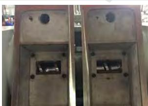
**Чтобы смесь не выходила из вентиляционных отверстий, рекомендуется закрыть их или загружать материал в шnek постепенно.** Если смесь выходит из вентиляционных отверстий увеличьте скорость шнека. Если на вашей машине вентиляционные отверстия работают через насос отключите его.
