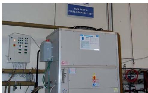
Производственный цикл подходит к концу на испытательном стенде. Здесь все модели чиллеров проходят индивидуальное тестирование для проверки правильности работы, заправки хладагеном и настроек микропроцессора.
