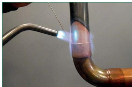
Все наши сварщики сертифицированы и постоянно проходят курсы улучшения техники сварки. Мы используем специальные сплавы с серебром, чтобы получать чрезвычайно безопасные и надежные швы, качество которых со временем не меняется.
