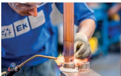
Следующий этап – это сборка охлаждающего контура, где собираются и припаиваются трубы контура, которые соединяются с различными агрегатами, (компрессорами, конденсаторами, испарителями и т. д.). Охлаждающий контур специально разработан таким образом, чтобы минимизировать потери нагрузки и избежать снижения производительности. Контур полностью изготовлен из медной трубы, в качестве припоя используется серебряный сплав. Он изолирован на всасывающей части, чтобы избежать образования конденсата.
