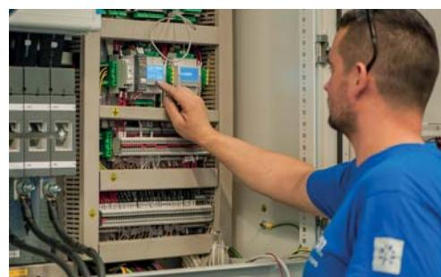
После сборки водяного и холодильного контура мы выполняем монтаж электропроводки между электрическими платами, компрессорами, вентиляторами, насосами и т.д. Каждый агрегат оснащен электрической панелью, собран, подключен и полностью протестирован на заводе. Нумерация проводов и оптимизированная компоновка упрощают поиск и устранение неисправностей. Установленные компоненты обозначены табличками с именами для упрощения идентификации.
