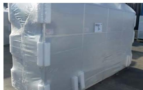
Последний этап производственного цикла – упаковка для отправки чиллера заказчику. Стандартная упаковка – это термоусаживаемая пластиковая пленка. Она покрывает весь чиллер и защищает его от пыли и влаги. На углах устанавливаются уголки из полистирола для защиты от возможных повреждений во время транспортировки. По желанию заказчика возможна специальная упаковка.
