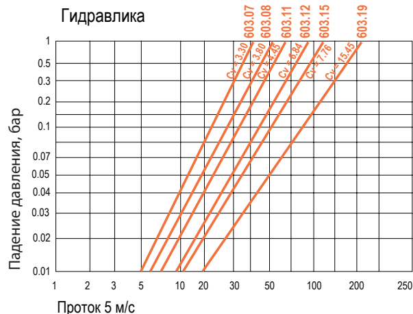
График зависимости протока от падения давления / Flow Rate vs Pressure Drop Graph
