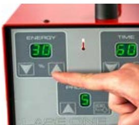
Селектор «ENERGY» помогает выбрать мощность дуги. Выражается в процентах от общей мощности устройства (200 Дж, 250 Дж и 300 Дж).
