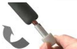
После заточки установите электрод, чтобы он выступал больше, чем необходимо. Направьте сварочную горелку вниз. Расположите зажимной инструмент и убедитесь, что электрод прилегает к регулируемому упору. Затяните электрод, вращая по часовой стрелке.
