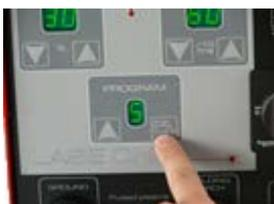
В любое время можно сохранить 9 программ, каждая из которых делает возможными различные комбинации мощности и времени. Информация сохраняется при нажатии и удерживании в течение 3 секунд сенсорной кнопки модуля «ПРОГРАММА». Для прокрутки программ просто нажмите стрелку вверх.
