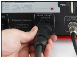
Подключение сварочной горелки (7), установить согласно направляющим, а затем по часовой стрелки зафиксировать гайку крепления.
