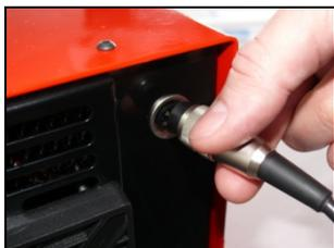
Подключите 4-контактный круглый штекерный разъем (светодиодное кольцо или разъем сварочной маски) к разъему на задней панели устройства (9).
