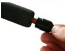
Установив сопло. Убедитесь, что электрод выступает на нужное значение, если это необходимо. Для обычного применения при перегрузке и сборке рекомендуется, чтобы электрод выступал на расстоянии примерно от 8 до 10 мм от сопла (используйте только оригинальные электроды).
