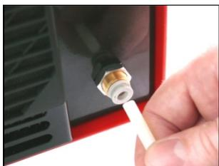
Подключите газовый шланг к манометру, а также к устройству (11).
