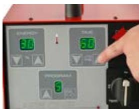
Переключатель «TIME» позволяет выбрать длительность импульса (например, 75 = 7,5 мс, стандартная длительность). Дисплей в десятых миллисекунд для большей точности. Длинный импульс характеризуется более глубоким проникновением и / или лучшим смешиванием материалов, которые трудно сваривать. Короткий импульс позволяет снизить теплопередачу тела металла.
