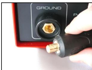
Подключить заземление к вилке, повернув ее на четверть оборота (5).
