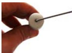
Регулировочный винт, расположенный сзади, помогает установить выступающую длину электрода относительно конца сопла с помощью шестигранного ключа.
