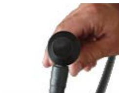
Открутите контргайку и ввинтите или выкрутите винт на задней стороне сварочной горелки, чтобы получить желаемое значение (от 1 до 5 мм). Короткая дуга будет точной; длинная дуга будет мощной. Для перезарядки мы рекомендуем отвод электрода примерно на 3 мм.
