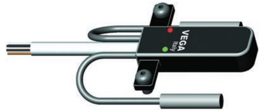
DME представила новый датчик Universal на замену выключателю REED HZ161U. Универсальный датчик сочетает в себе магнитный датчик REED и индуктивный магнитный датчик, за счет чего значительно уменьшается интерференция, вызванная присутствием металлических объектов (таких, как стальные крепежные плиты форм). Повышается точность данных по сравнению со старым датчиком REED.
